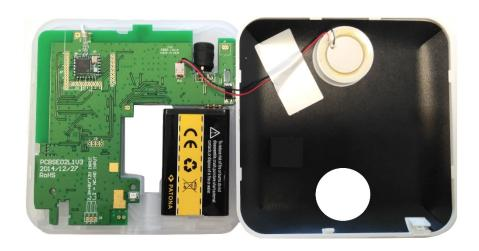
Sobald das Gerät dem Home Control-Netzwerk hinzugefügt ist, wird automatisch ein Demontagealarm aktiviert, der bei Entfernen der Sirene von der Gehäusehalterung für 3 Minuten auslöst. Schalten Sie den Alarm in der Weboberfläche des Home Control-Portals stumm, bevor Sie die Alarmsirene von der Montageplatte entfernen.
