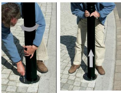
Version amovible avec clé triangulaire 11 mm. La manche est fabriquée en acier galvanisé, le mécanisme en inox. Obturateur fixe qui ne laisse pas de trou quand le potelet est enlevé. Démontable pour l'entretien.
