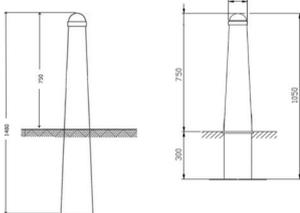
Extra: Version amovible au moyen d'un socle en acier galvanisé. Mécanisme de fermeture composé d'un axe fileté en inox, de 16 mm de diamètre et d'un écrou de verrouillage en bronze. Le verrouillage s'effectue à l'aide d'une clé (fournie) par une ouverture dans la tête sphérique.
