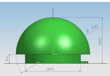
L'utilisation de demi-spheres, comme une alternative pour le potelet classique, a l'avantage que le risque de dommages consécutifs à des tiers est évité et que les dommages directs seront, dans la plupart des cas, limités au véhicule entrant en collision. Les risques de dommages du demi-sphère lui-même est très limité. Ceci évite les réparations et/ou des remplacements de votre mobilier urbain.
