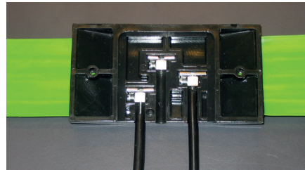
Verbindungsstück von hinten gesehen, mit sichtbaren Klemmen.
