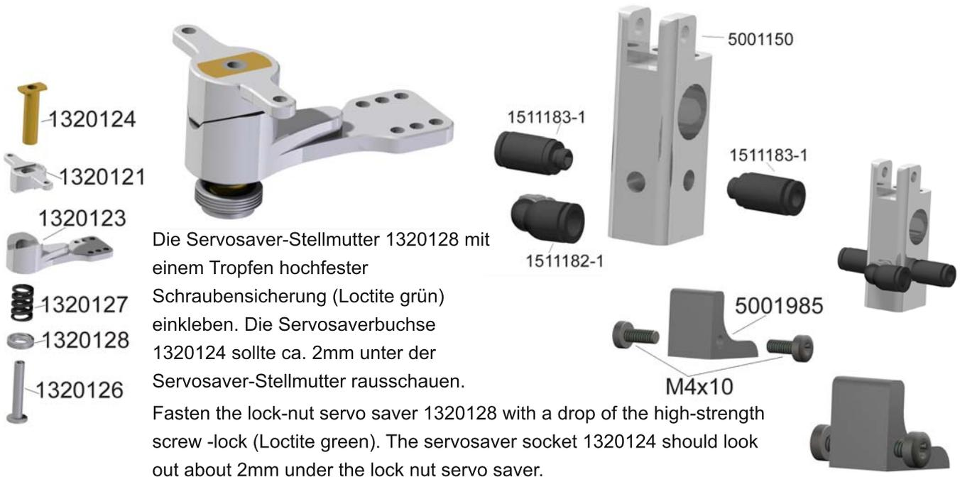
Die M4x10 Schrauben an der Fuss-Stütze nicht ganz einschrauben, damit hier später der O-Ring zur Befestigung der Füße eingehängt werden kann.
