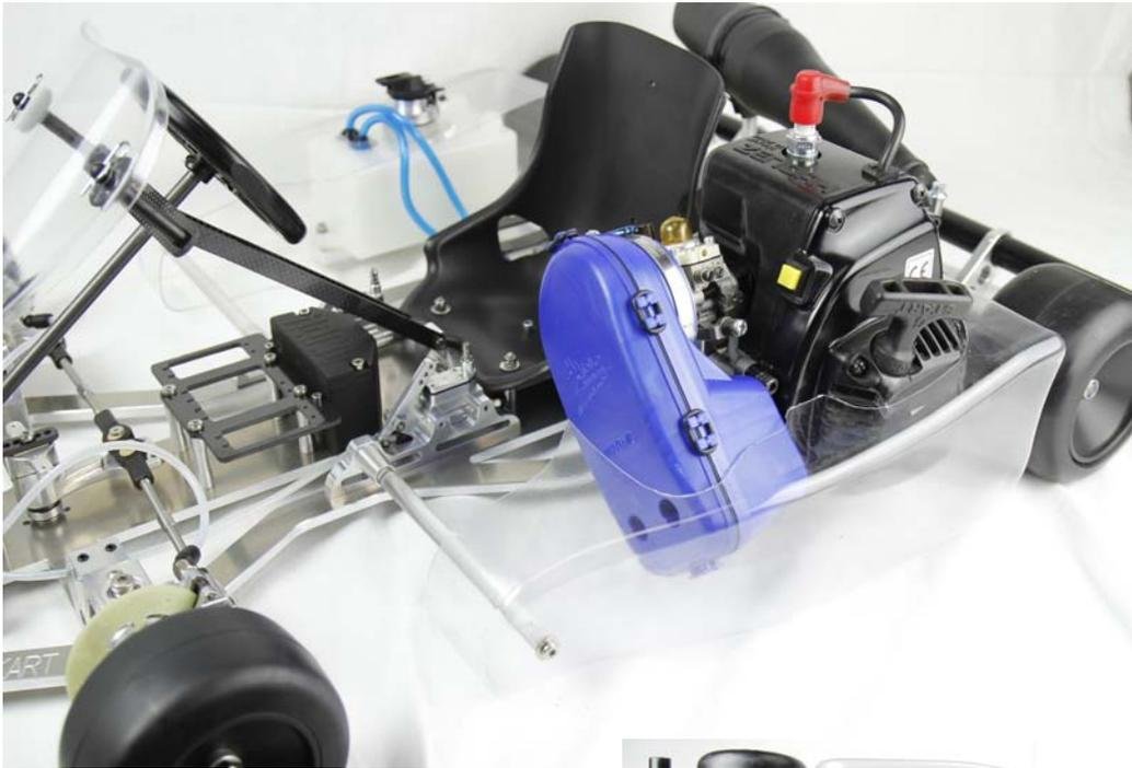
Die Seitenkästen werden an der vorderen Stütze mit jeweils einer M4x10 Schraube und Unterlagscheibe befestigt. The side boxes are fastened to the front support with an M4x10 screw and washer.
