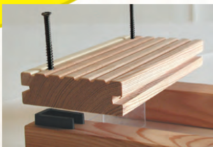
Anfangs-/Abschlusskomponente als Abstandshalter unter die erste Diele setzen. Der Quersteg muss nach oben zeigen. Anfangsdielen vorbohren.
