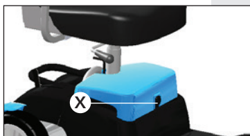
Contact chargeur batterie
