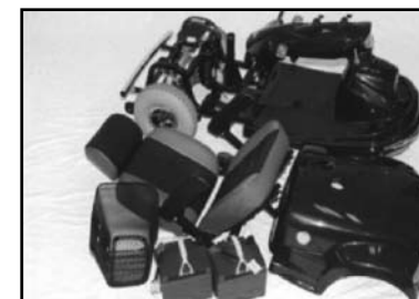
Afb. 7: Na de demontage van de scootmobiel blijven er 5 hoofdcomponenten over.
