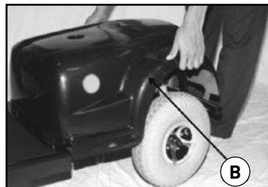
Afb. 2: Verwijder de achterkap (B) van de scootmobiel
