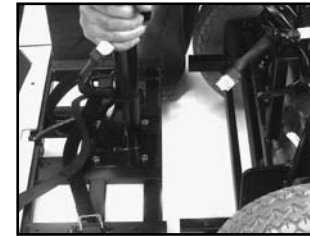
Afb. 11 Trek het voor en-achter chassis uit elkaar
