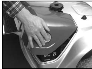
Afb. 2 Verwijder de kap van de accubak
