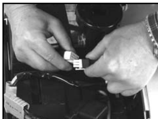
Afb. 5 Ontkoppel de witte stekker
