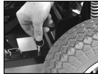
Afb. 10 Verwijder de borgpen links en rechts
