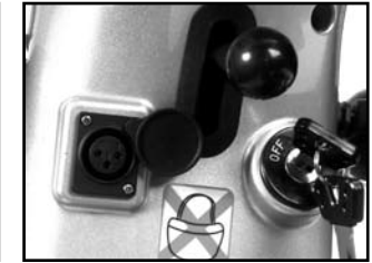
Afb. 9 Duw de instelhendel van de stuurkolom naar beneden om het gehele stuurkolom naar beneden te plaatsen
