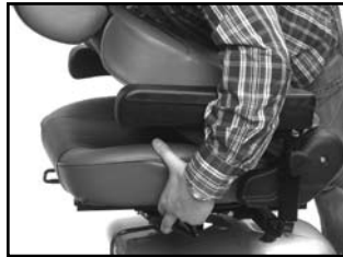
Afb. 1 Ontgrendel de hendel van de draaiunit om de stoel omhoog te tillen
