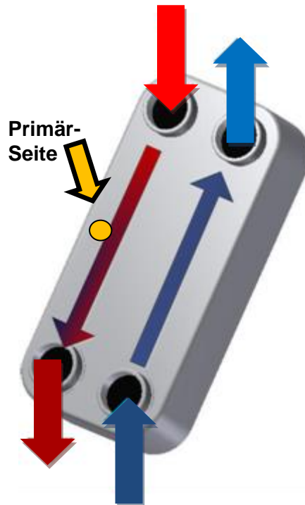
Abbildung 2: Allg. empfohlene Strömungsrichtung bei Plattenwärmeübertragern sowie die Kennzeichnung der Primärseite durch einen Punkt.
