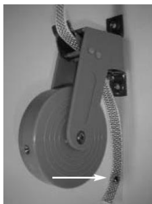
Plaats het schroefje door het ingeknipte band.
