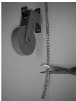
Knip het band ± 25 cm Voorbij de bandopwinder af.
