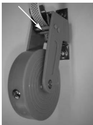
Voer het band over de 2 stuks cilinders door de rem.
