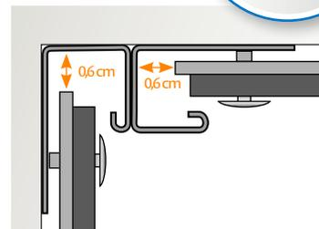
Placez le profil en J sur les côtés latéraux de la fenêtre, de la porte, ou des angles intérieurs.
