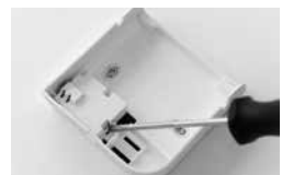
Stap 3: Open de klep op de basisplaat om de elek- trische aansluitingen zichtbaar te maken.
