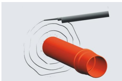
Afb. 4 Het aanbrengen van de lijm op de wand
