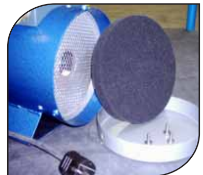
Turbine/motor en filter
