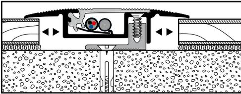
**Übergangsprofil Kabelkanal 7 - 16 mm**
