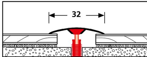
**Fix Übergangsprofil 0-20 mm**
