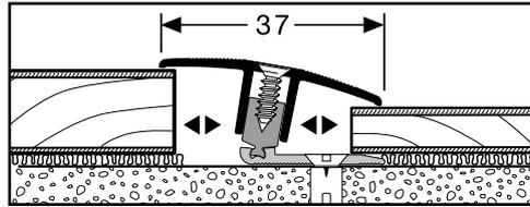
**Schraub Übergangsprofil 7-17 / 27 mm**
