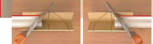
8 Legen Sie die Leiste ordnungsgemäß ausgerichtet in die Gehrungslade ein und führen Sie den Schnitt wohlgemerkt am richtigen Ende aus. Wenn der Winkel nicht ganz korrekt ist, können Sie ihn mit einem Cuttermesser oder Schleifpapier ein wenig nachbearbeiten.
