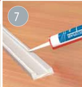
8 Gehen Sie wieder zum Ausgangspunkt zurück: Sie können jetzt an den 2 ebenen Flächen auf der Rückseite der Wandleiste, d. h. an der Kontaktfläche mit der Wand, vollflächig Kleber auftragen. Stellen Sie sicher, dass die Klebefläche sauber und staubfrei ist. Legen Sie die Wandleiste an die Schlagschnurlinie an und drücken Sie sie leicht an, bis oben und unten überschüssiger Kleber austritt. Halten Sie die Leiste kurze Zeit in Position.
