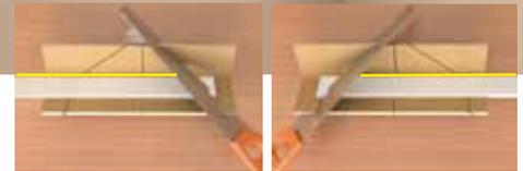
4 Legen Sie die Wandleiste ordnungsgemäß ausgerichtet in die Gehrungslade ein und führen Sie den Schnittwohlgemerkt am richtigen Ende aus.
