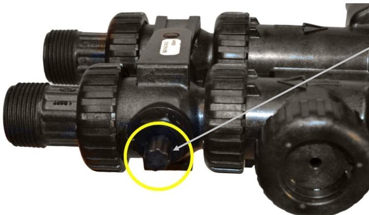
Verschneideventil zum Einstellen der Verschnitthärte. Ganz nach links gedreht bedeutet Wasserhärte ca. 0°dH. Ganz nach rechts gedreht bedeutet Wasserhärte ~ 5°dH - 8°dH (abhängig von der Rohwasserhärte)
