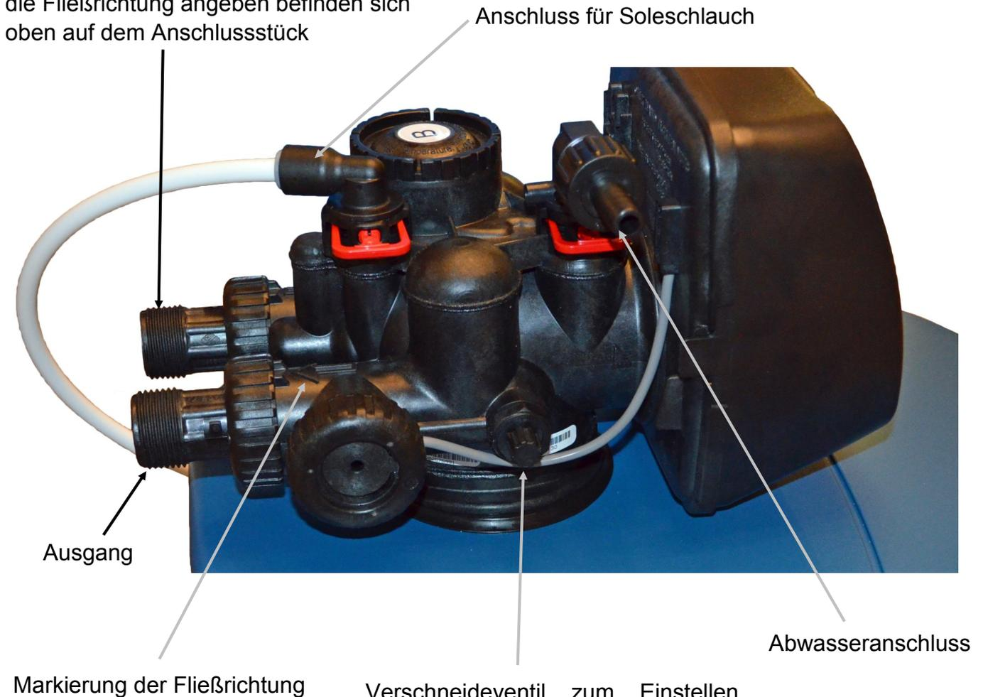
Verschneideventil zum Einstellen der Verschnitthärte. Ganz nach links gedreht bedeutet Wasserhärte ca. 0°dH. Ganz nach rechts gedreht bedeutet Wasserhärte ~ 5°dH - 8°dH (abhängig von der Rohwasserhärte)
