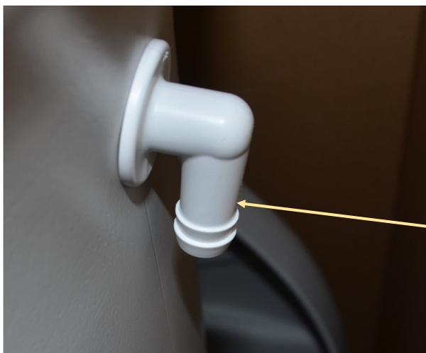
Der Anschluss für den Überlaufschlauch befindet sich an der Rückseite des Gehäuses hier einfach den Überlaufschlauch 1/2" aufschieben.
