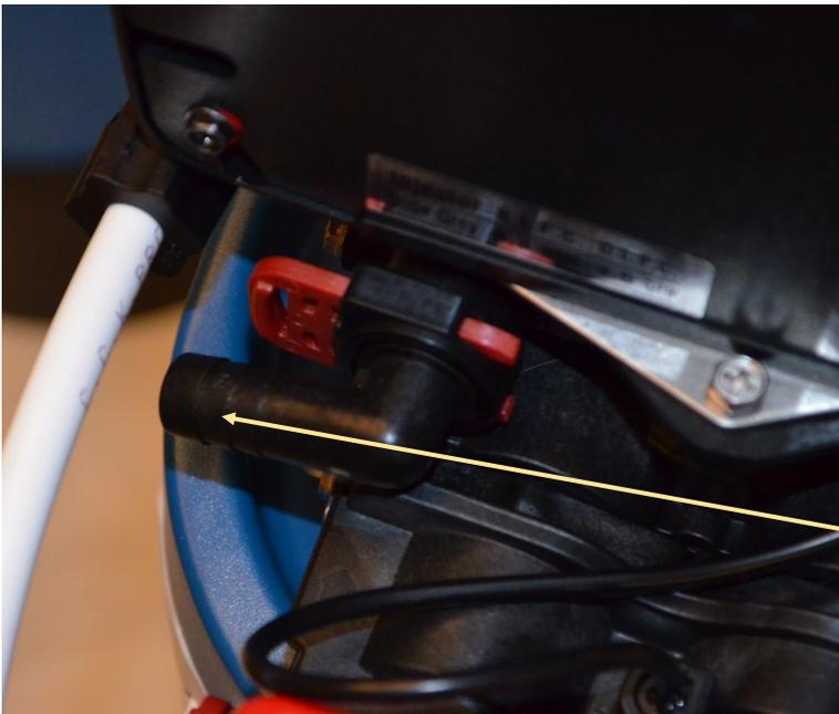
Abwasserschlauch 1/2" aufschieben und mit der Schlauchschelle festklemmen.
