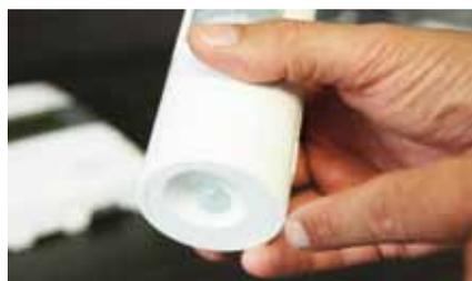
Der Bewegungsmelder von HomeMatic ist mit Unterkriechschutz ausgerüstet, der den Überwachungswinkel von 90° vergrößert.
