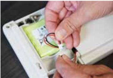
Jede Zentrale benötigt einen Notstromakku. Mit diesen soll die Funktionsfähigkeit der Anlage bei einem eventuellen Stromausfall aufrecht erhalten werden.
