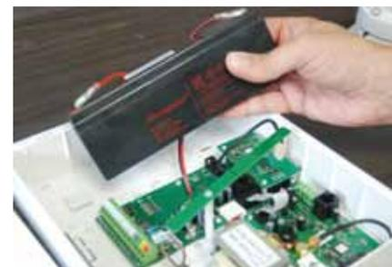
Ein 12 Volt-Akku sichert die Alarmanlage gegen plötzlichen Stromausfall ab.
