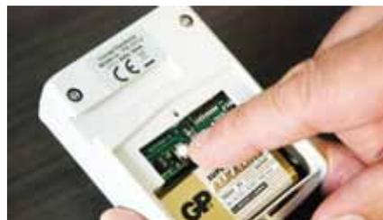
Dieser Knopf muss gedrückt werden, um die Sensoren im System (Conrad) zu registrieren bzw. um die Sensoren anzulernen.
