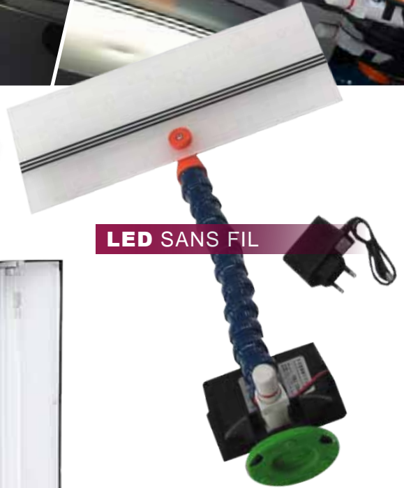
13928 Lampe de Débosselage à LED 12v Sans fil avec batterie au lithium rechargeable avec ventouse et "col de cygne" flexible.
