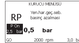
Şekil 18: Yeniden başlatma basıncının ayarlanması
