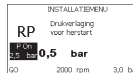
Afb. 18: Instelling van de herstartdruk
