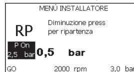
Figura 18: Impostazione della pressione di ripartenza
