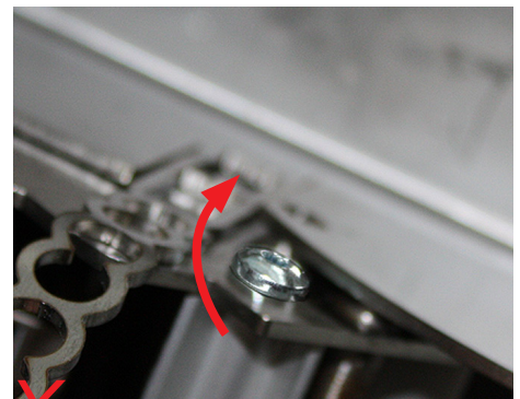
✗ Falsch / Wrong Lasche behindert die Schraube. Schraube kann nicht wegtauchen. / Metal strap not bent back inhibits the screw movement.
