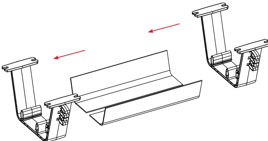
EVoline Rail kann wahlweise auch mit nur einem Aluminiumprofil oder ganz ohne Aluminiumprofile montiert werden. / As an option EVoline Rail can be used with just one aluminium profile or without profiles
