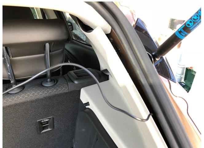
Das Kabel wird nun auf der Beifahrerseite bis nach vorne zum Interface verlegt und dort wieder angeschlossen.
