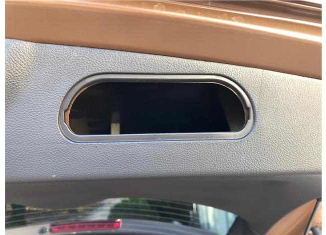
Nun müssen die schwarzen Muttern gelöst werden. Danach noch die gelben Plastiknieten entfernen und von außen kann vorsichtig die große Blende abgebaut werden. Dabei ist darauf zu achten, dass die Kabel der Kennzeichenleuchte noch gelöst werden.
