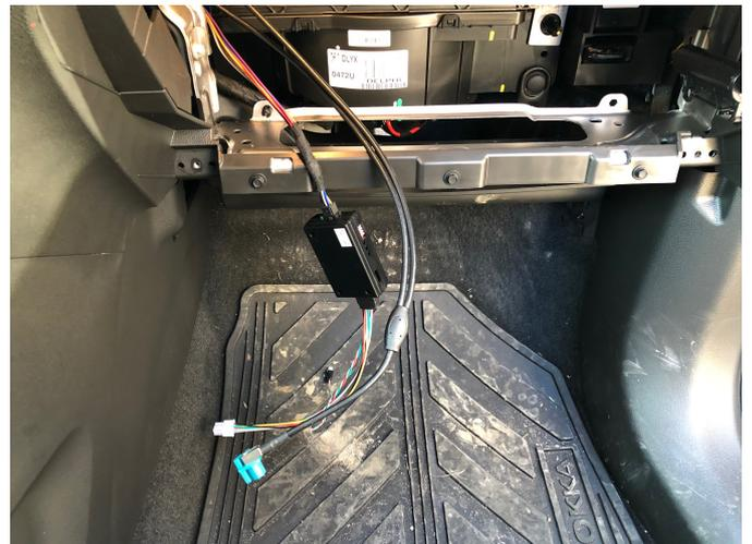
Der blaue und der weiße Stecker werden nun an das Interface angeschlossen. Im folgenden muss noch die Rückfahrkamera angeschlossen werden.
