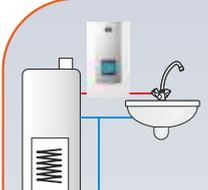
Solaranlage tauglich zur Nachwärmung von vorgewärmtem Wasser geeignet. Die Einlauftemperatur darf nicht 70°C überschreiten.
