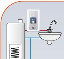
Solaranlage tauglich zur Nachwärmung von vorgewärmten Wasser geeignet. Wassertemperatur bei Betriebsspannung bis 70°C.
