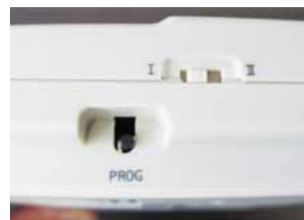
Mit diesen Tasten kann der Programmiermodus aktiviert werden und der interne Signalgeber ausgewählt werden.
