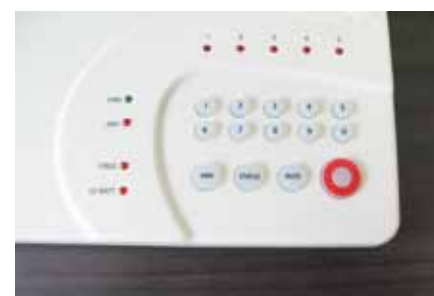
Die Zentrale ist als einziges Gerät im Test nicht mit einem Display ausgestattet; die Kommunikation erfolgt über die Sprachausgabe.
