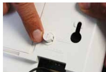
Auf der Rückseite der Bodenplatte muss der Sabotagekontakt auf „Box and Wall“ gestellt werden.
