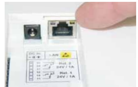
Die Anschlüsse für Strom und LAN-Verbindung sind frei zugänglich in die Bodenplatte integriert.
