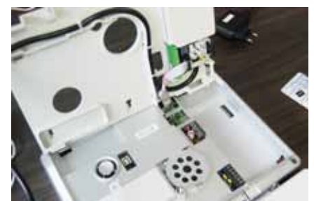
Das Innenleben der qualitativ hochwertigen Alarmzentrale wird durch zusätzliche Platten und Böden vor Umwelteinflüssen geschützt.
