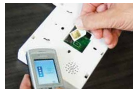
Auf der Unterseite der Zentrale kann eine SIM-Karte in ein Modul eingesetzt werden.
