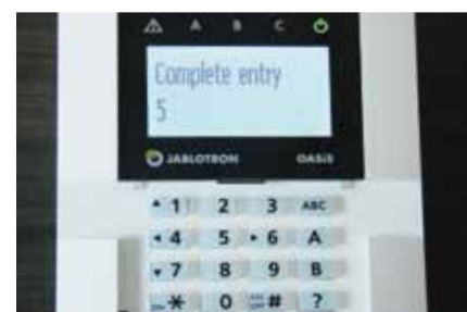
Die Tastatur ist über Funk mit der Zentrale verbunden; Befehle werden so via Signal weitergegeben.
