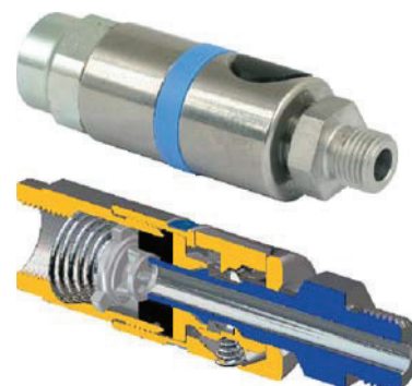
Doorsnede van Stäubli RCS, de lange geleiding is goed zichtbaar
