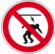
Pic. 231 Aanraken van sterkstroomkabel verboden
