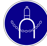
Pic. 604 Verplicht gasfles met ketting voorzien
