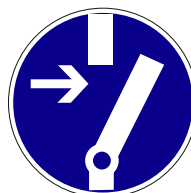
Pic. 278 Schakelen voor ingebruikname
