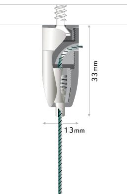
**IT** tirante per cavi con sistema autobloccante, fissaggio a soffitto per cavi di acciaio. montare il tirante a soffitto, inserire il cavo nel morsetto e regolare la tensione e la lunghezza del cavo grazie al forellino laterale. il meccanismo di autobloccaggio trattiene il cavo. spessore del cavo: max. Ø1,8mm.
