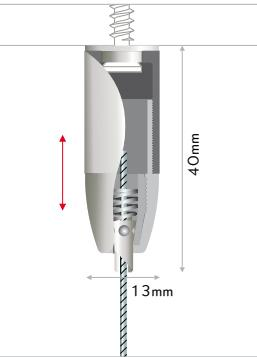
**IT** tirante per cavi, sistema in tensione autobloccante. montare il tirante ed inserire il cavo: il sistema di autobloccaggio lo trattiene automaticamente. regolare la tensione del cavo avvitando il tirante. spessore del cavo: max. Ø1,8mm.
