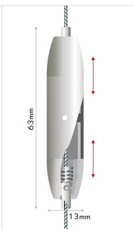
**IT** tensionatore per cavi con sistema autobloccante. per un'ottima tensione di cavi molto lunghi. inserire l'estremità del cavo in link, dove il sistema autobloccante lo tratterrà, e regolare la tensione avitandolo. il forellino centrale garantisce un avitamento più stretto. spessore del cavo: max Ø1,8mm.
