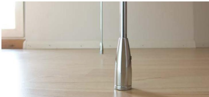
**IT** base di appoggio regolabile per astine. inserire l'astina nella base e fissarla con la brugola laterale. grazie alla regolabilità data dall'avitamento si può scegliere la lunghezza desiderata, si possono eliminare piccole irregolarità del pavimento e l'astina viene tenuta perfettamente in tensione. spess. astina: Ø6mm.
