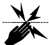
Merkinnän pitää olla vedenkestäävä, vähintään 25 mm korkea kytlin kummallakin puolella. On tärkeää, että sähköaitauspiiriin kytkeytä verkkokäyttöiset apulaiteet ovat aitauspiiriin ja verkon väillä eristyksellään samaa tasoa kuin itse paimenlaiteen.
