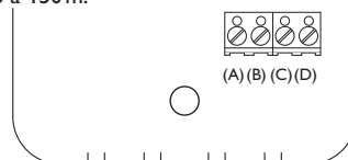
Morsetti del modulo di comunicazione
